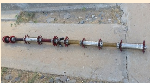
Рис. 14. Оборудование ООО «Интрон Плюс» для внутритрубного контроля стальных промышленных трубопроводов
