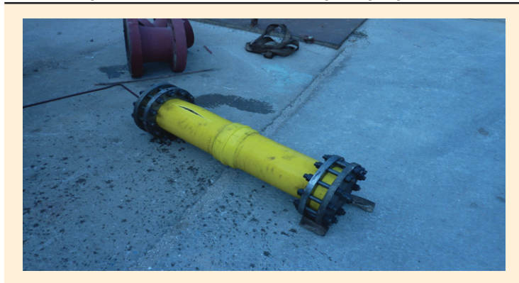
Рис. 7. Гидроиспытание МПТ-225 в ГУП «Черноморнефтегаз»
