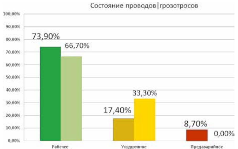
Рис. 8. Результаты диагностики проводов/грозотросов на ВЛ 35–110 кВ, проконтролированных в филиалах ОАО «Ленэнерго» в 2011–2013 гг.
