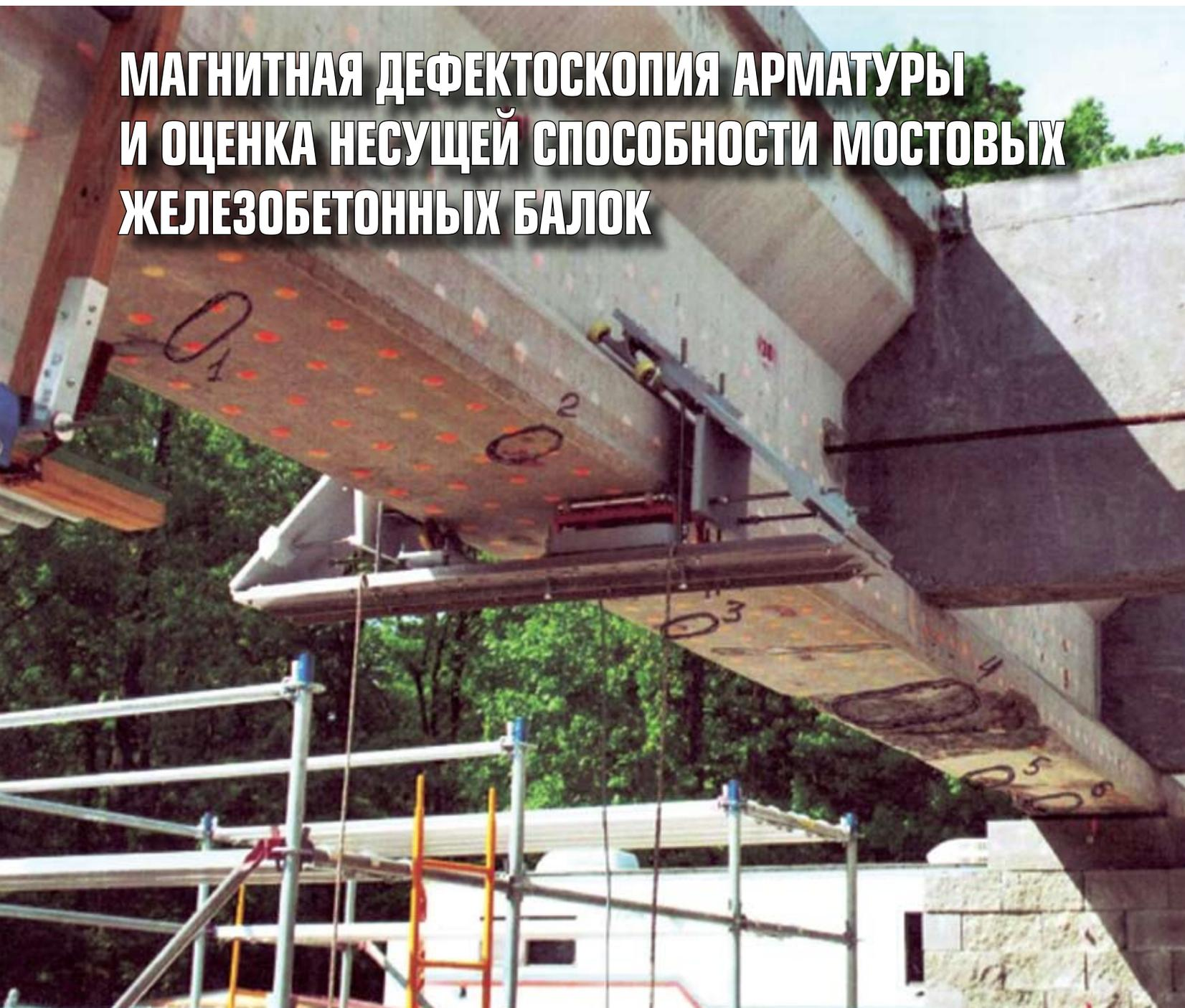
**Н**еразрушающий контроль может быть применен во время специальных и предпроектных обследований конструкций мостовых сооружений и, при необходимости, в рамках приемочных обследований после выполнения ремонта и реконструкции мостовых сооружений. Объем и периодичность проведения магнитной дефектоскопии арматуры как инструментального исследования установлены в ОДМ 218.4.001-
